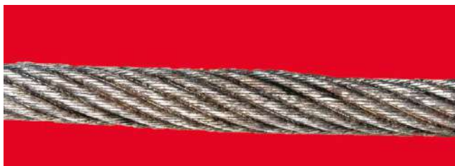
l. Lokale Zunahme des Seildurchmessers aufgrund von Kernverzerrung
