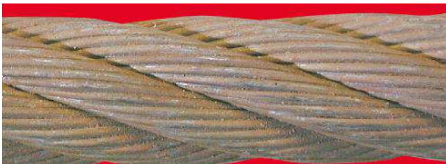
a. Beginn der Oberflächenoxidation, kann abgewischt werden, oberflächlich - Bewertung: 0% in Richtung Entsorgung
