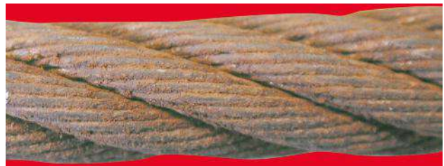
b. Drähte rau anzufassen, allgemeine Oberflächenoxidation - Bewertung: 20% in Richtung Entsorgung
