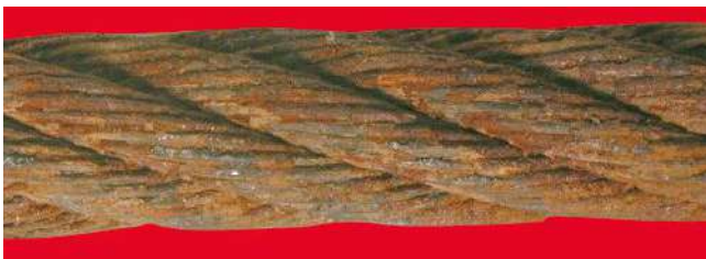
c. Drahtoberfläche jetzt stark von Oxidation betroffen - Bewertung: 60% in Richtung Verwerfen
