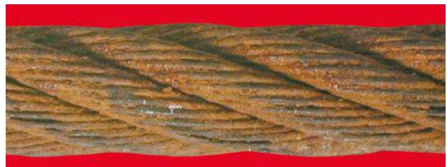
d. Oberfläche stark narbig und Drähte ziemlich locker, Lücken zwischen Drähten - sofort entsorgen
